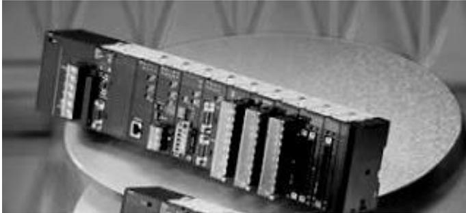
Gambar 3.1 PLC Tipe Modular (sumber: tuliskan disini)
